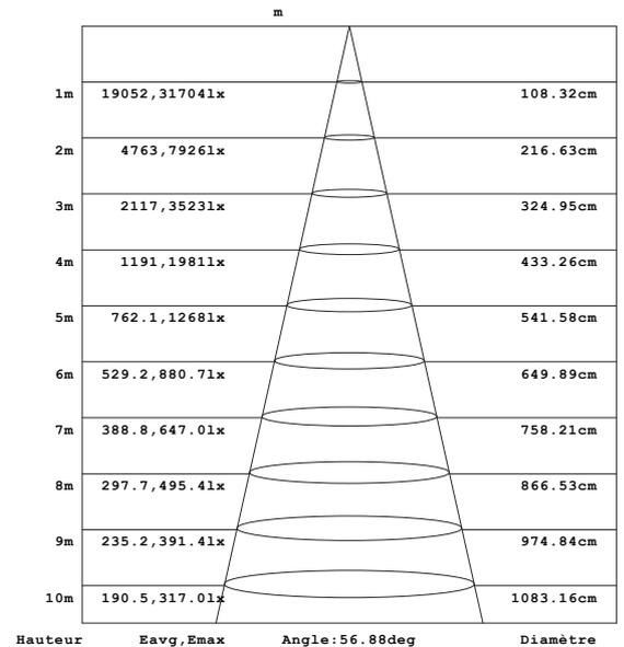
Note: Les courbes indiquent la zone éclairée et la moyenne d'éclairage lorsque le luminaire est à une distance différente.
